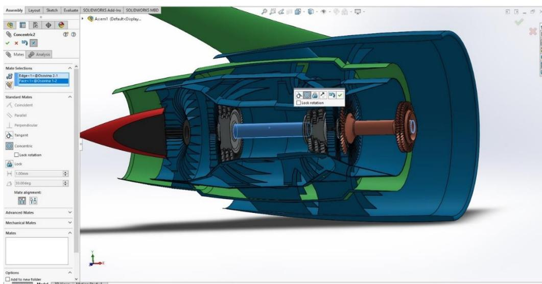
Slika 69. Koncentrično spajanje osovine 02 s osovinom 01
