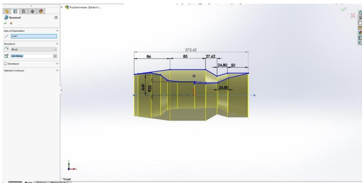
Slika 7. Prostorna konstrukcijska naredba Revolve
