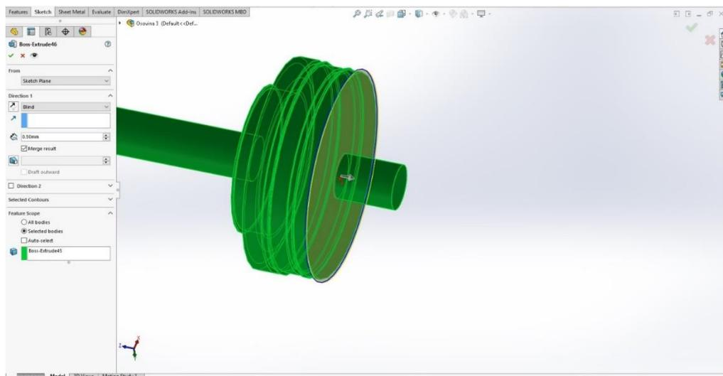
**Slika 50.** Nosač ventilatora
