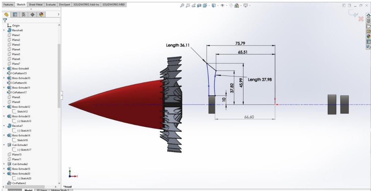
**Slika 16.** Aerodinamični oblik usmjerivača fluida
