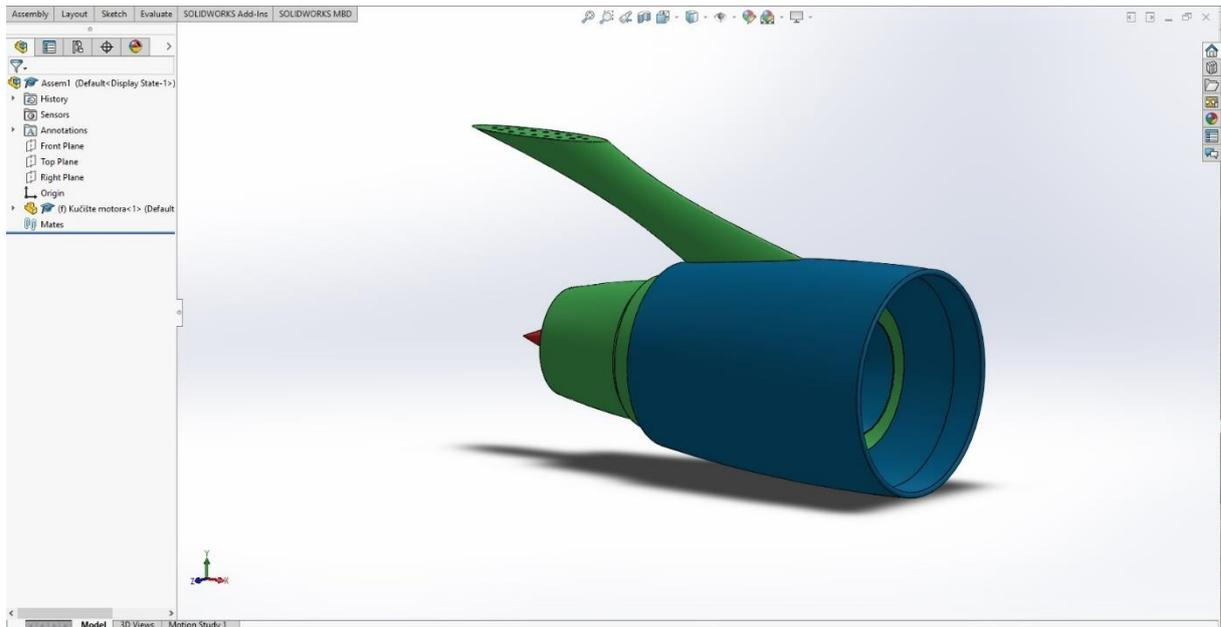
Slika 64. Kućište mlaznog motora kao baza za sklapanje
