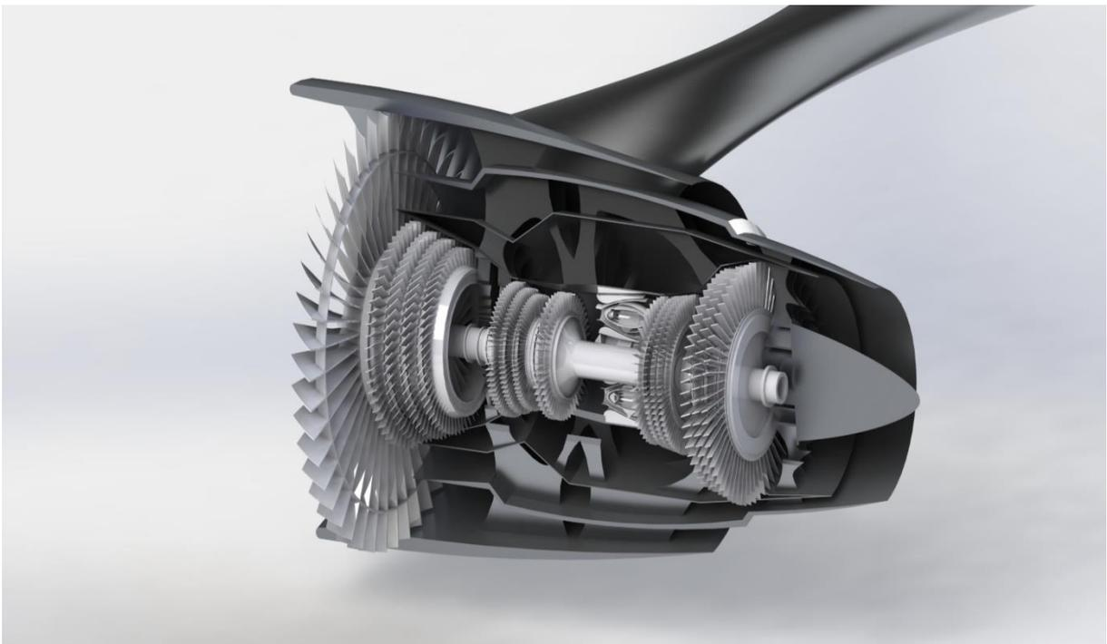
**Slika 77.** Presjek modela mlaznog motora
