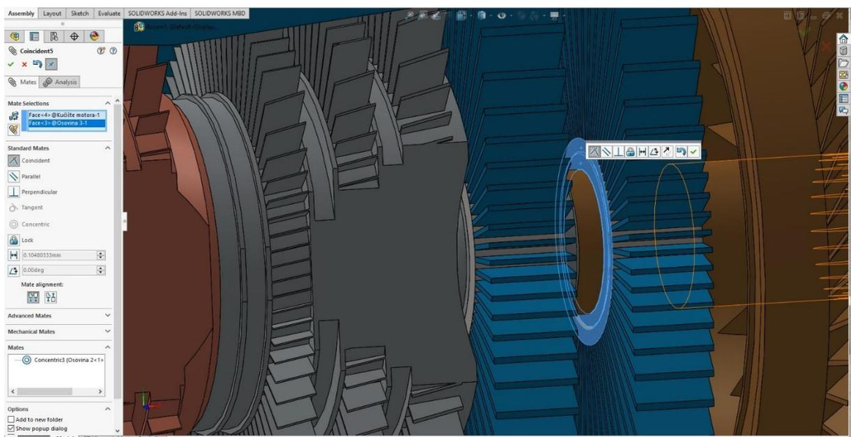
Slika 73. Spajanje lica osovine 02 i osovine 03
