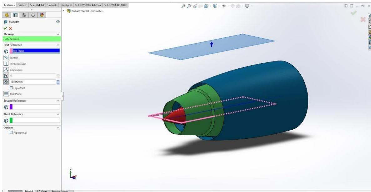
**Slika 21.** Ravnina za konstruiranje pilona mlaznog motora
