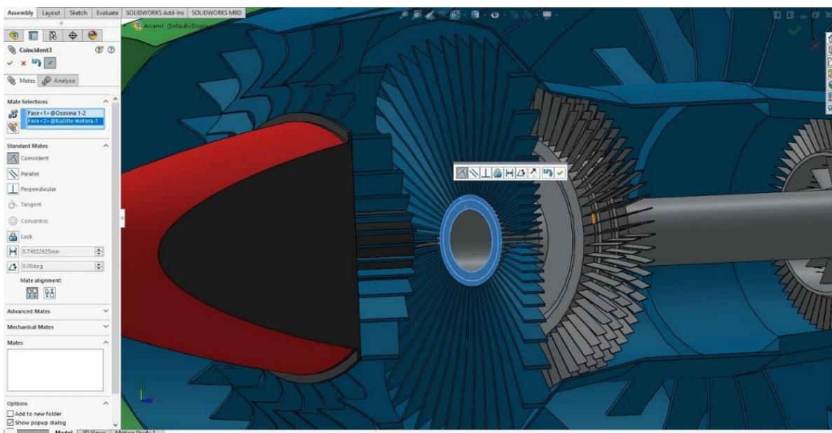
Slika 67. Poravnanje osovine 01 s rukavcem kućišta
