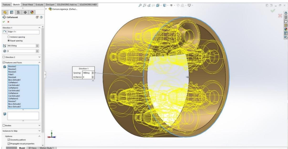
Slika 58. Raspodjela sklopa kućišta plamena i zraka
