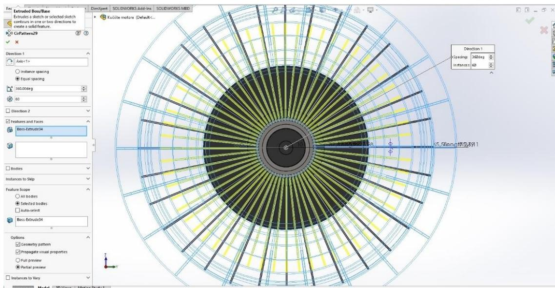
Slika 17. Raspodjela usmjerivača fluida na osi X
