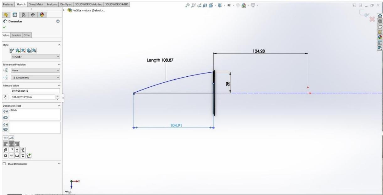
**Slika 12.** Konstrukcija vrha mlaznice naredbom *Line* i *Spline*
