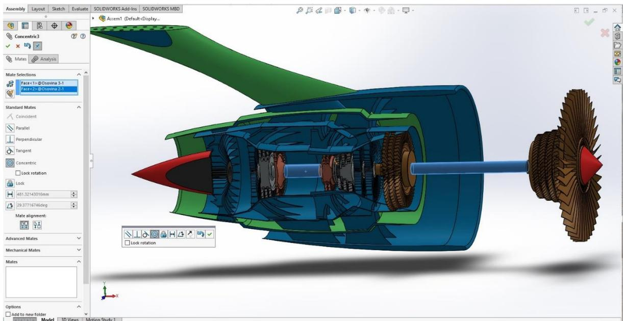
Slika 72. Koncentrično spajanje osovine 02 s osovino 03
