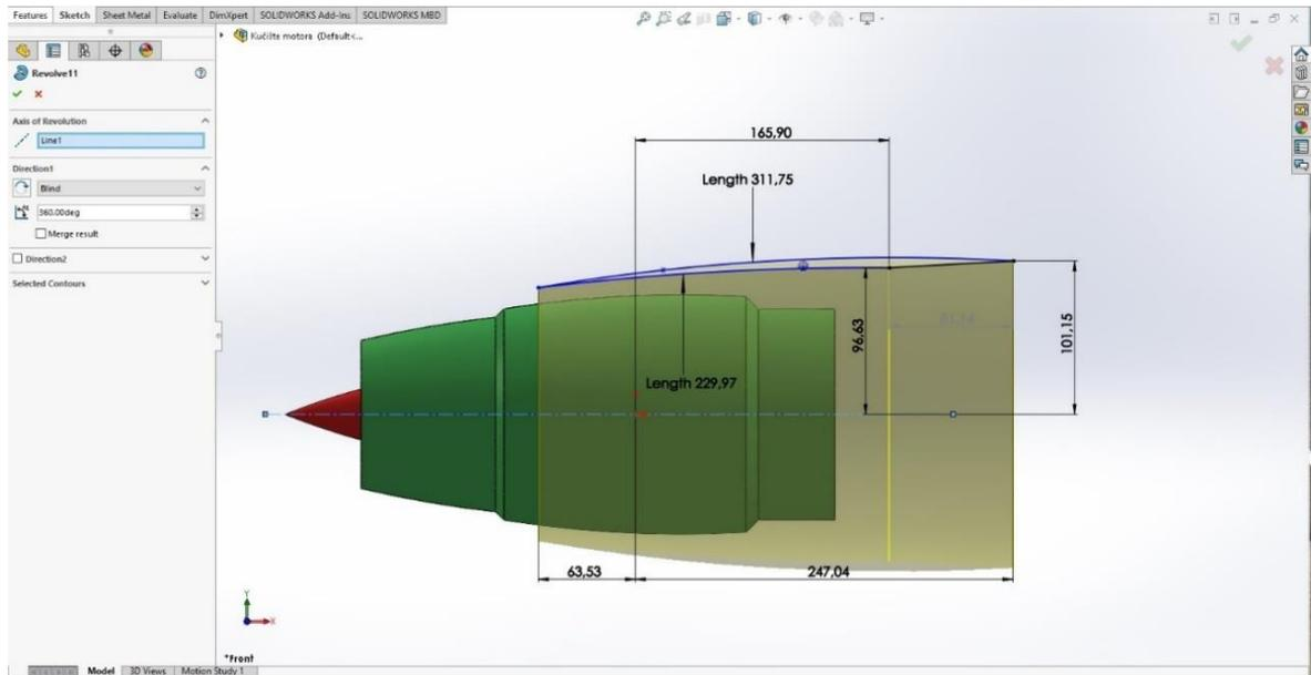
Slika 19. Model vanjskog kućišta motora
