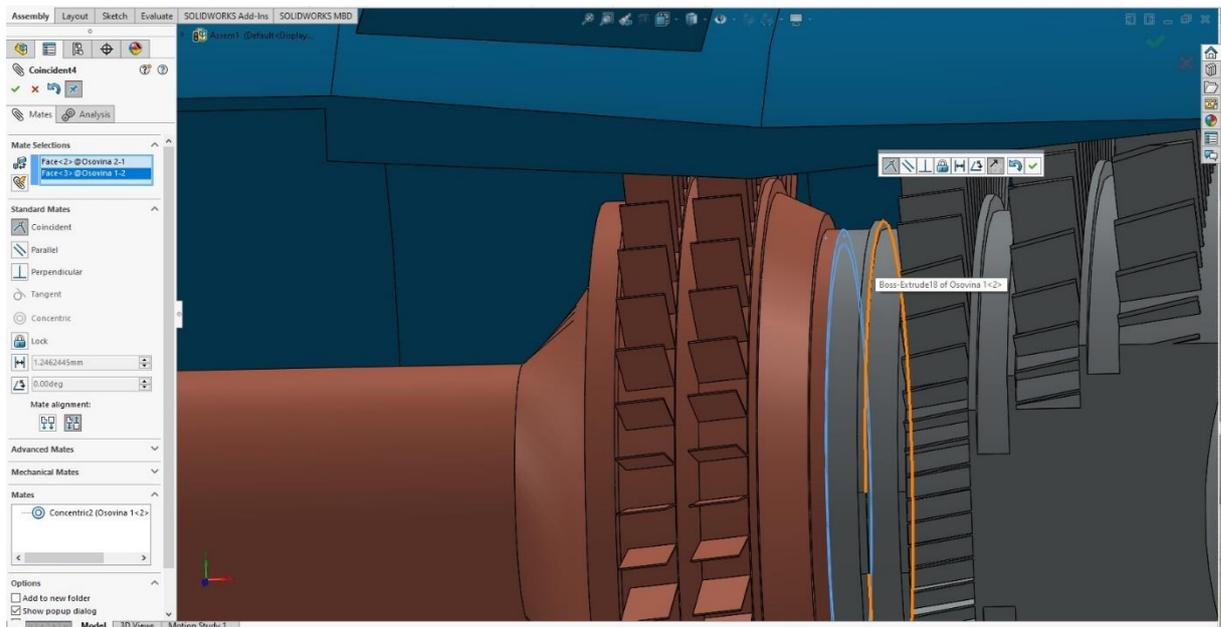
Slika 70. Spajanje lica osovine 01 i osovine 02
