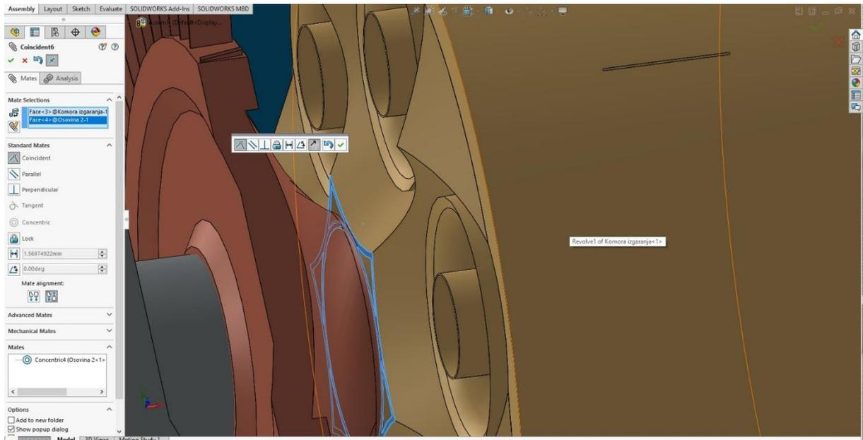
**Slika 76.** Spajanje lica osovine 02 i komore izgaranja
