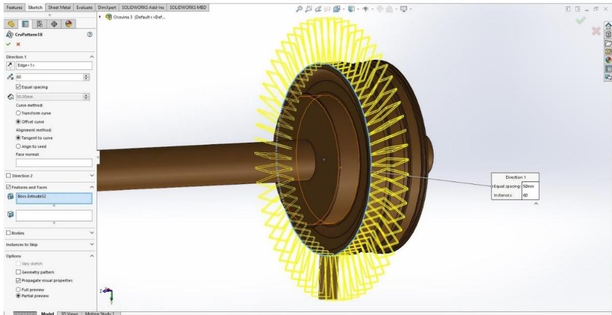
Slika 52. Kružno razmještanje lopatica po obodu nosača ventilatora
