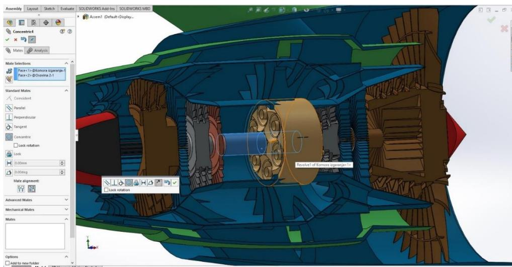
Slika 75. Koncentrično spajanje osovine 02 s komorom izgaranja
