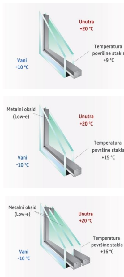
Slika 12. Presjeci IZO-stakala s odnosima temperatura kod konstantne vanjske i unutarnje temperature zraka
