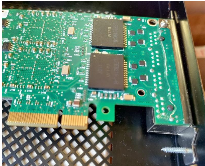
Slika 22. Popravak mrežne kartice korištenjem epoxy smole
