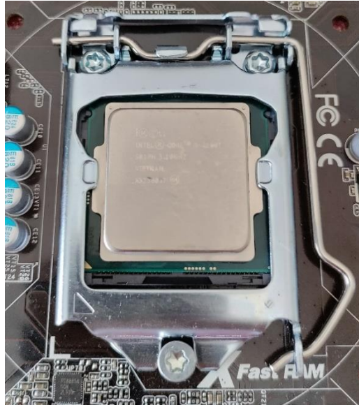
Slika 15. Instalacija centralne procesorske jedinice
