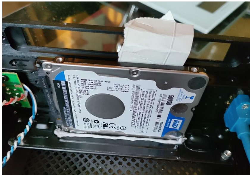
Slika 23. Ugradnja tvrdog diska korištenjem epoxy smole
