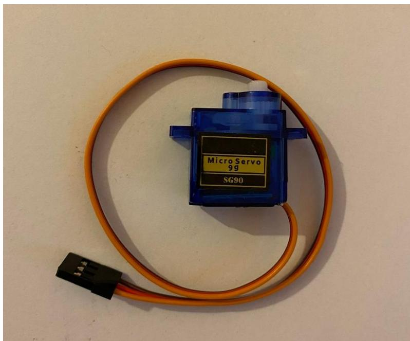
Slika 6. SG90 servo motor.
