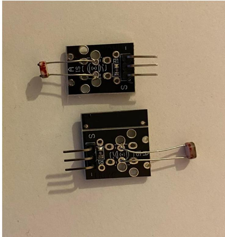
Slika 10. Fotoelektrični senzor.
