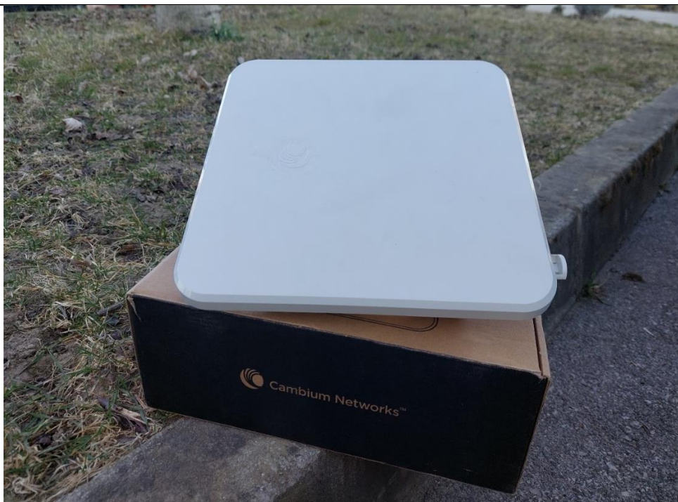
Slika 9. Cambium force 300-19 pretplatnički modul Izvor: Autor
