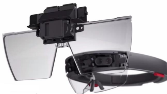
Slika 5. Kombinirane leće Izvor: https://www.microsoft.com/en-us/hololens (datum pristupa: 20.09.2021.)
