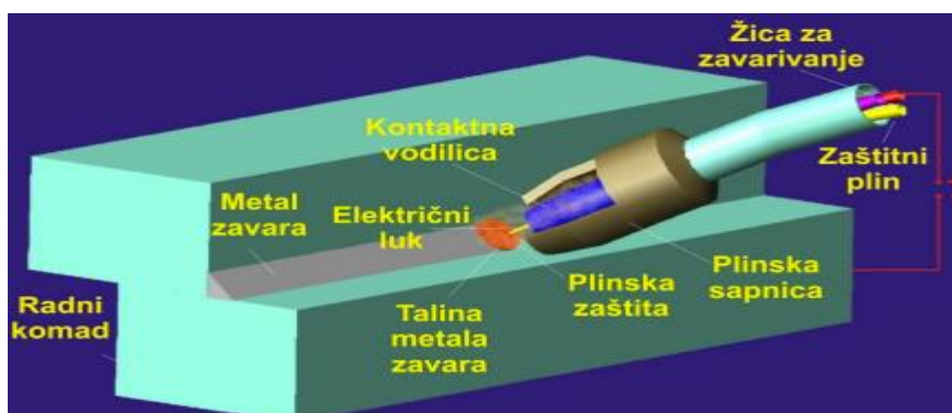
Slika 5. MIG/ MAG zavarivanje
