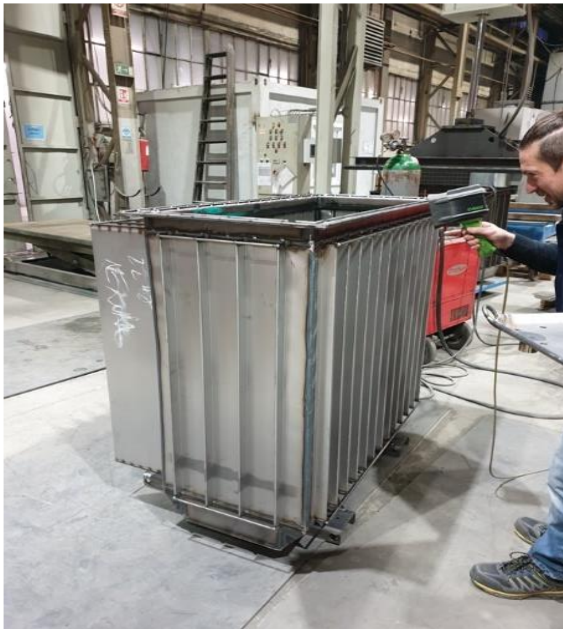
Slika 13. Ispitivanje UV lampom
