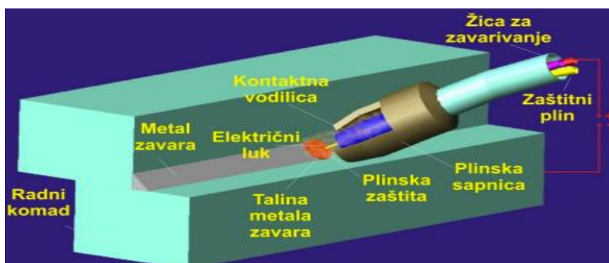
Slika 5. MIG/ MAG zavarivanje
