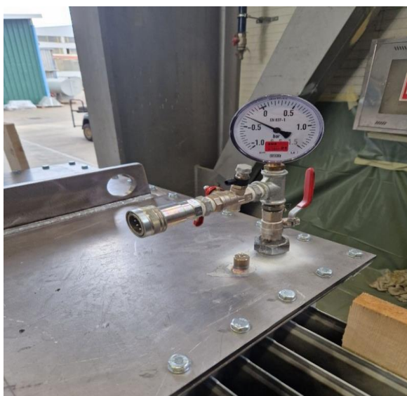
Slika 31. Manometar s vrijednošću od -0,3 bara
