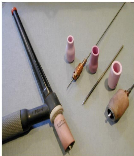
Slika 15. Pištolj za TIG zavarivanje
