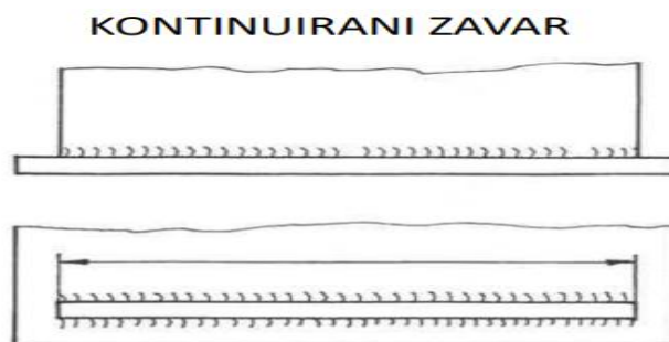
Slika 4. Kontinuirani zavareni spoj
