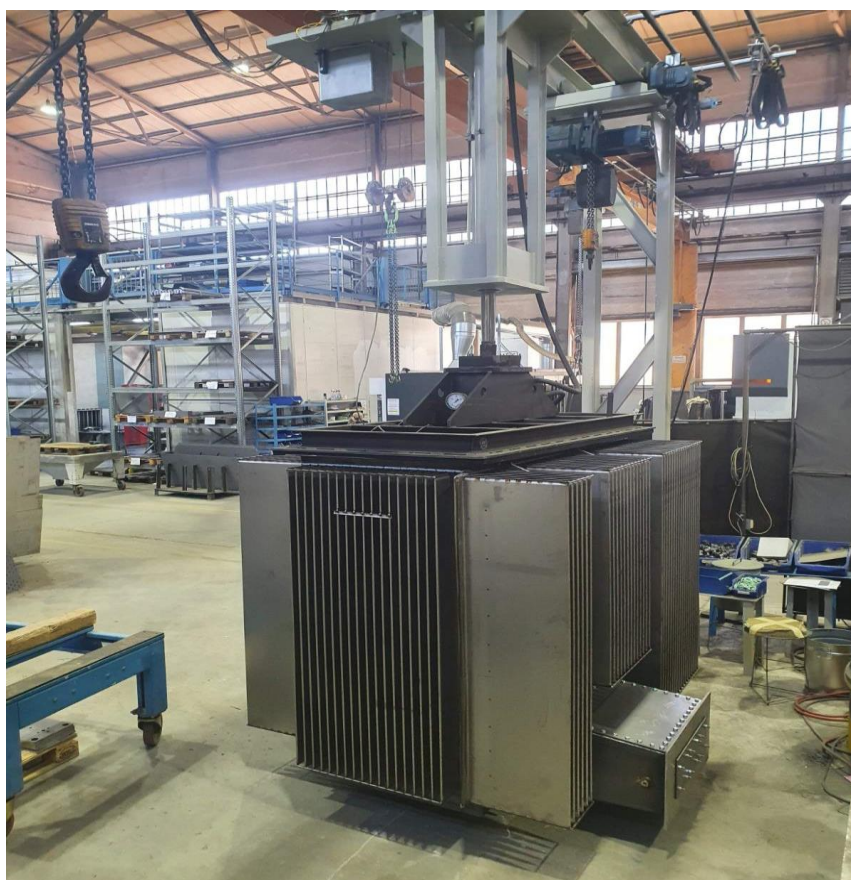
Slika 17. Tlačno opterećivanje kotla
