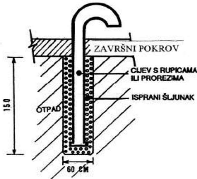
**Slika 7.** Shema sustava za pasivno otplinjavanje odlagališnih plinova
