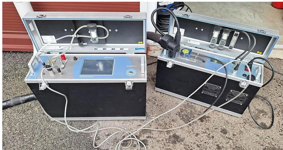
**Slika 9.** Analizator dimnih plinova proizvođača "Madur electronics" [31]
