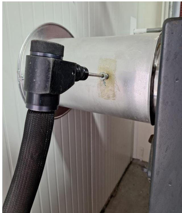
**Slika 12.** Sonda za uzorkovanje umetnuta u odvodni kanal [31]
