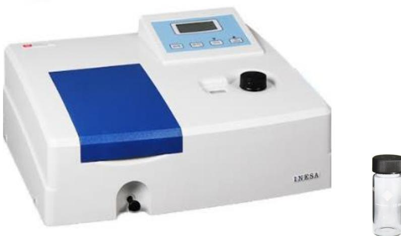
**Slika 12.** Spektrofotometar i kiveta za spektrofotometar
