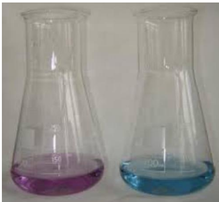
Slika 20. Promjena boje prilikom titracije
