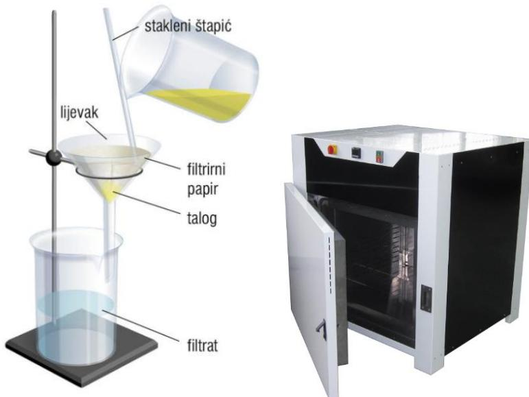
**Slika 9.** Prikaz filtracije i laboratorijska peć za sušenje
