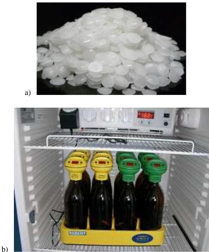
**Slika 13.** a) Natrijev hidroksid u ljuskicama i b) Oxitop na staklenim tamnim bocama
