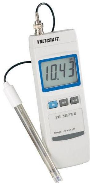
**Slika 6.** Digitalni pH metar
