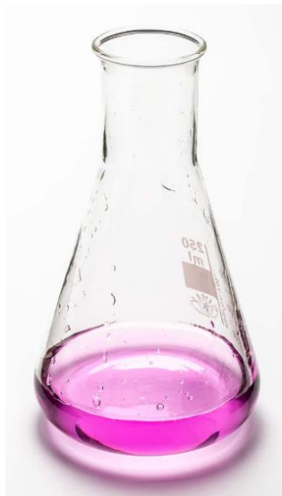
Slika 15. Erlenmeyerova tikvica s uzorkom kod kojeg se vidi prisutnost nitrita
