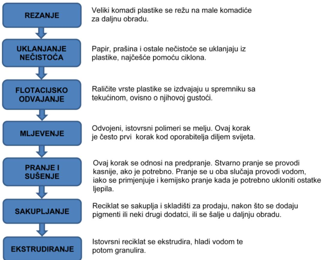
Slika 5. Shema mehaničkog recikliranja plastičnog otpada [12]
