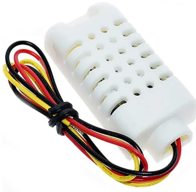
Slika 6. AM2302 senzor za temperaturu i vlažnost zraka Izvor: http://skr.rs/zGH7 (pristup: 02.03.2024.)
