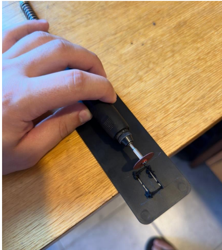
Slika 35. Rezanje otvora za OLED zaslon
