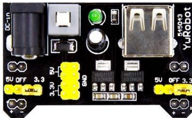
Slika 12. Naponski regulator YwRobot MB-V2
