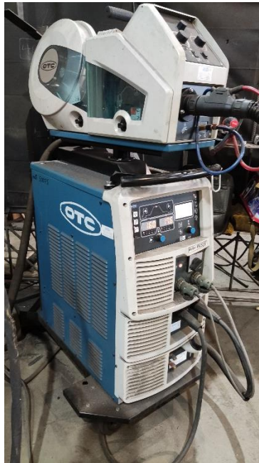
Slika 21. Aparat za zavarivanje OTC P452E
