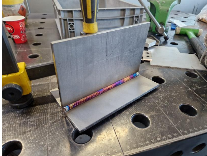
Slika 66. – Proba 6mm zavarena TIG postupkom
