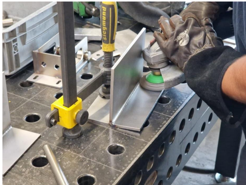
Slika 68. – Završna obrada zavara
