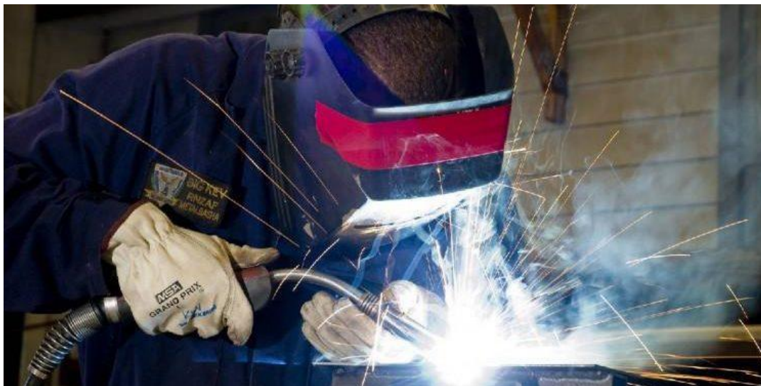
Slika 1. – Zavarivanje MIG/MAG postupkom
