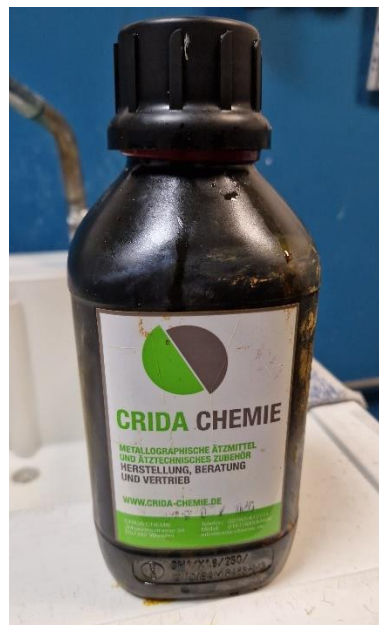
Slika 74. – Dušična kiselina za jetkanje zavara
