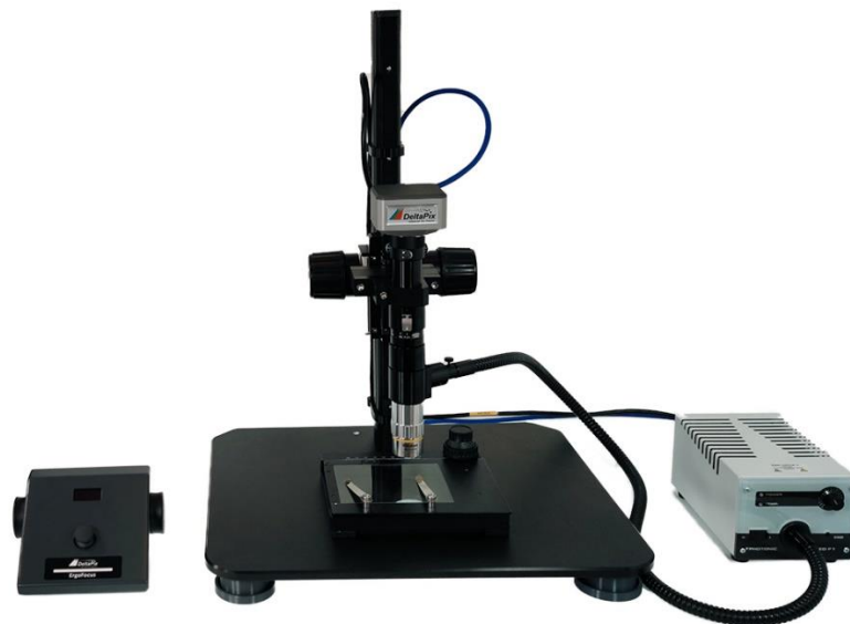
Slika 37. – Digitalni mikroskop za snimanje makroizbrusaka
