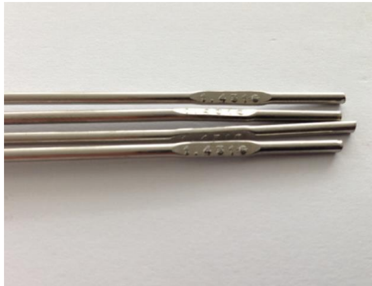
Slika 45. – Žica za TIG zavarivanje s oznakom
