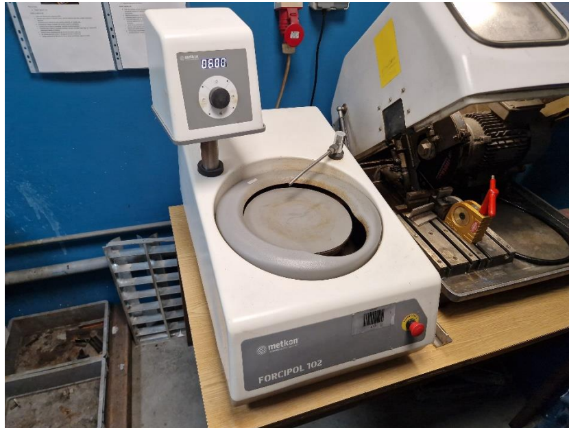
Slika 71. – Metalografska brusilica i polirka Metkon FORCIPOL 102
