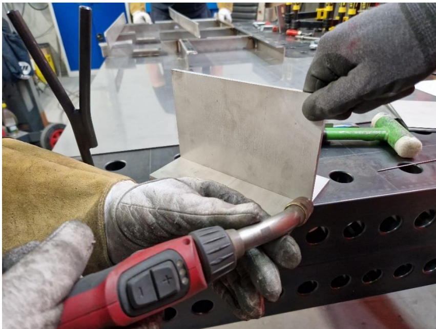
Slika 63. – Točkasto zavarivanje pločica MAG postupkom
