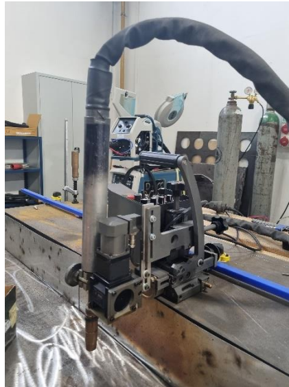
Slika 22. Pištolj i vodilica za D-Arc zavarivanje
