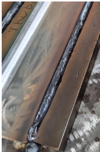
Slika 26. Kutni zavar D-Arc postupkom
