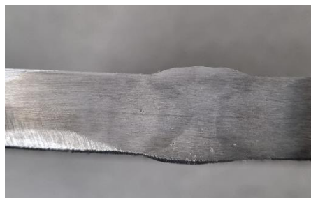
Slika 28. Makroizbrusak sučeljenog spoja zavarenog konvencionalnim MAG postupkom
