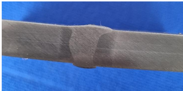
Slika 30. Makroizbrusak sučeljenog spoja zavarenog visokoučinskim D-Arc postupkom
