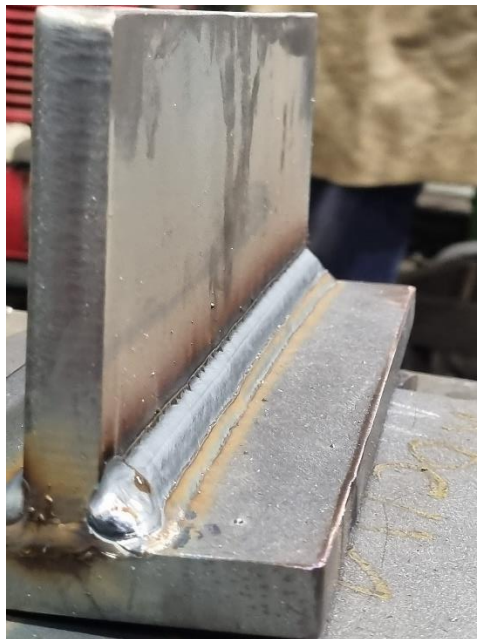
Slika 20. Zavareni kutni zavar sa 3 prolaza
