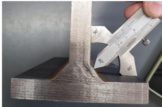
Slika 27. Mjerenje veličine zavora pomičnim mjerilom
