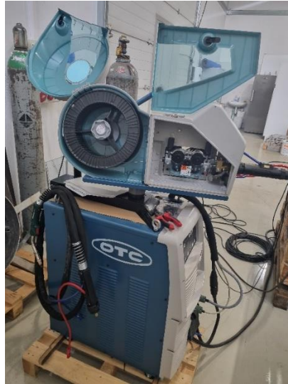
Slika 21. Oprema za D-Arc zavarivanje
