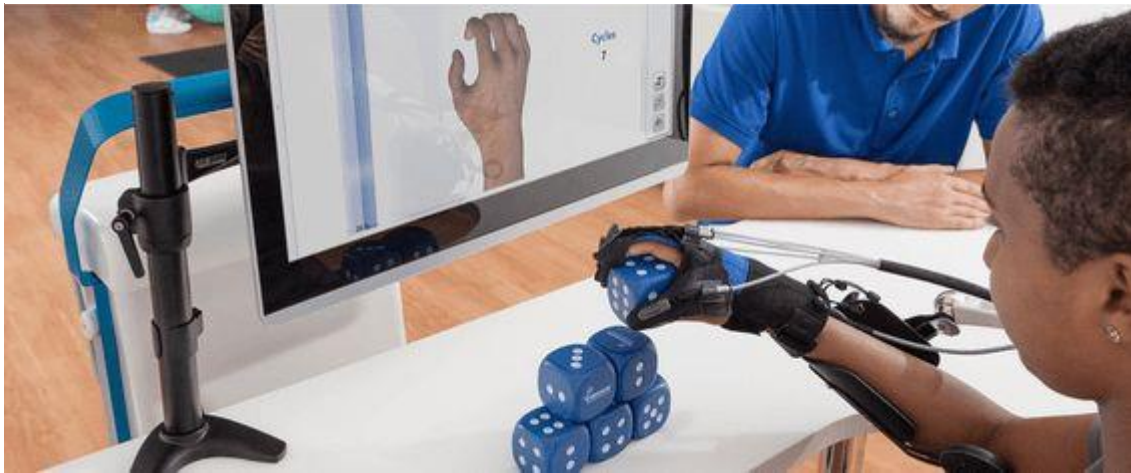
Slika 10. Primjer primjene robotskog uređaja za rehabilitaciju ruku
