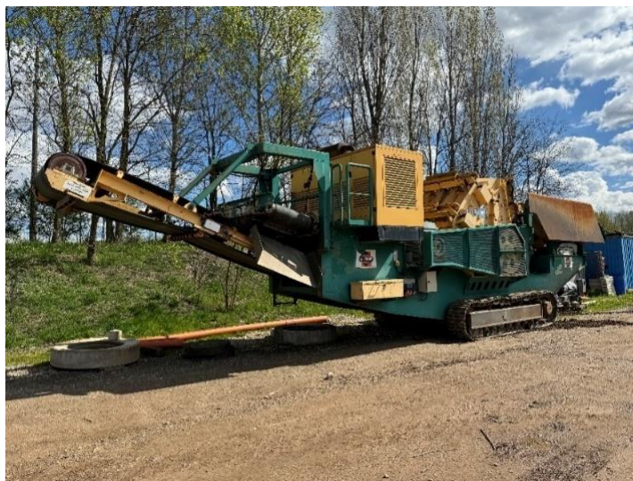
Slika 9. Udarna drobilica MFL RCI 100/130 [5]
