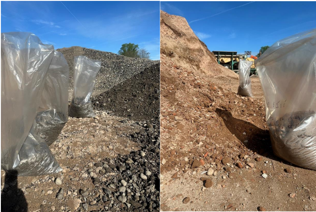
Slika 14. Uzimanje uzoraka za ispitivanje recikliranog agregata [5]
