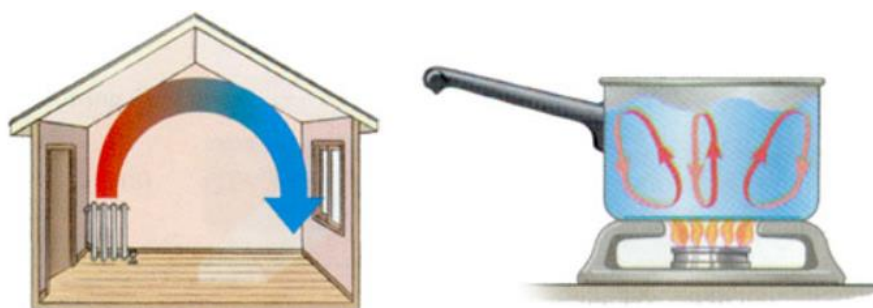
Slika 9: Toplinska struja (konvekcija)[4]
