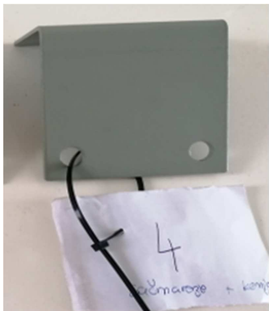
d) Sačmaren + kemijski obrađen testni uzorak
