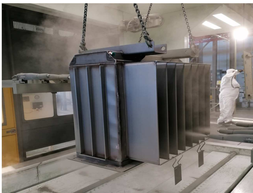
Slika 27. Nanos praha na testne uzorke u Wagner kabini
