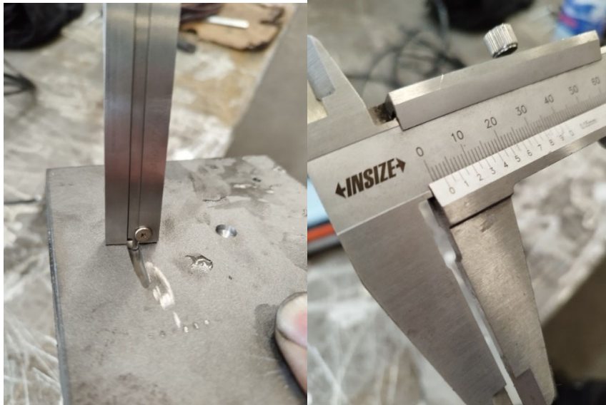
Slika 20. Analogni prikaz dubine oštećenja na limu
