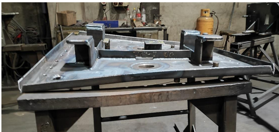
Slika 18. Deformacija materijala tijekom procesne kontrole
