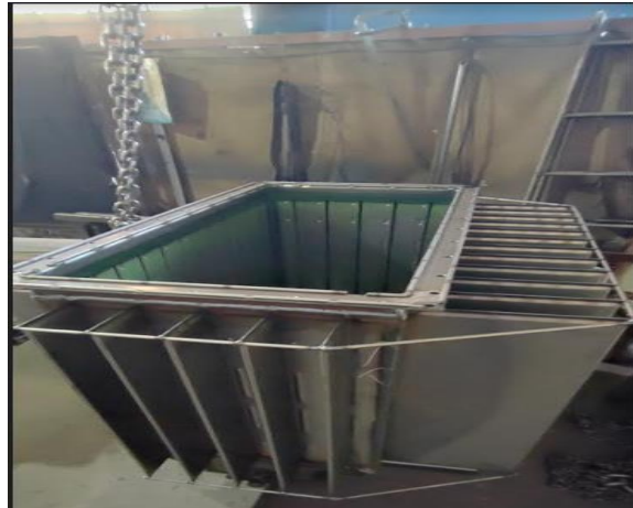
Slika 26. Mazanje kotla sa fluorescentnim penetrantom
