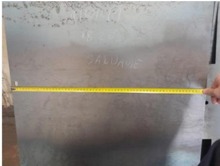
Slika 17. Dimenzijska kontrola materijala
