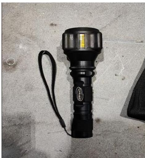
Slika 41. UV lampa za ispitivanje kotla
