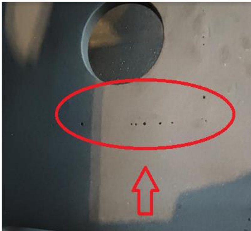
Slika 48. Poroznost na pobrušenom zavararu
