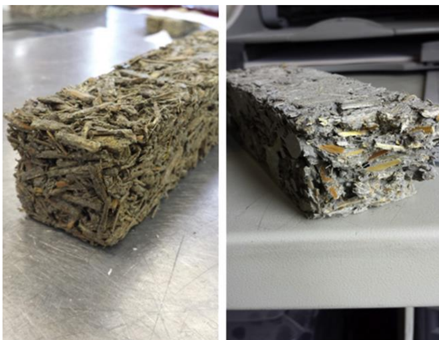
Slika 4: Lagani beton na bazi biomase miskantusa [9]
