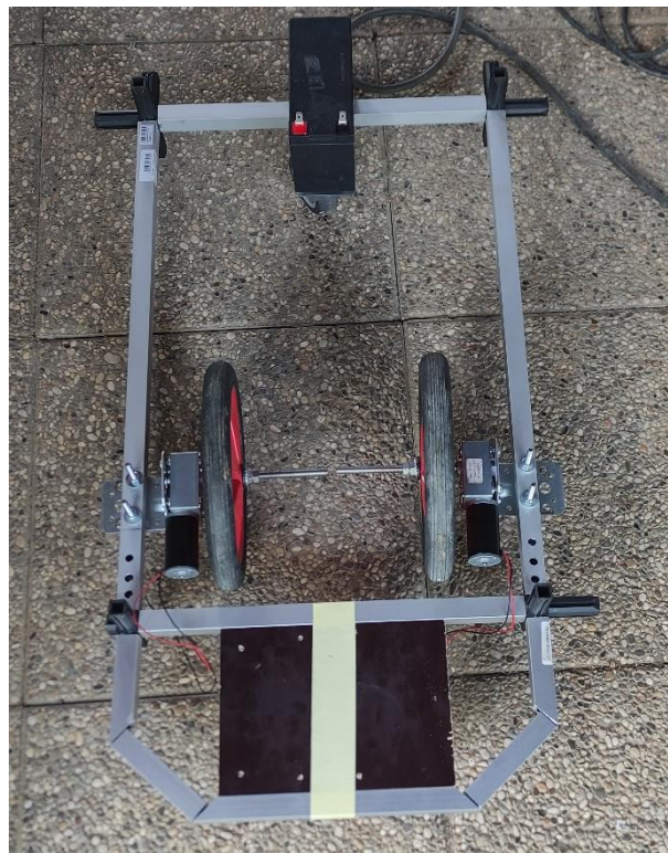
Slika 14. Izrada konstrukcije kosilice. Izvor: Nenad Vagan.
