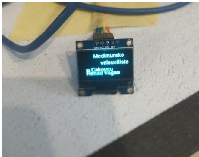
Slika 7. OLED ekran 0.96. Izvor: Nenad Vagan.
