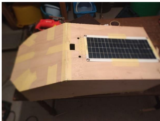
Slika 16. Lijepljenje poklopca kosilice. Izvor: Nenad Vagan.
