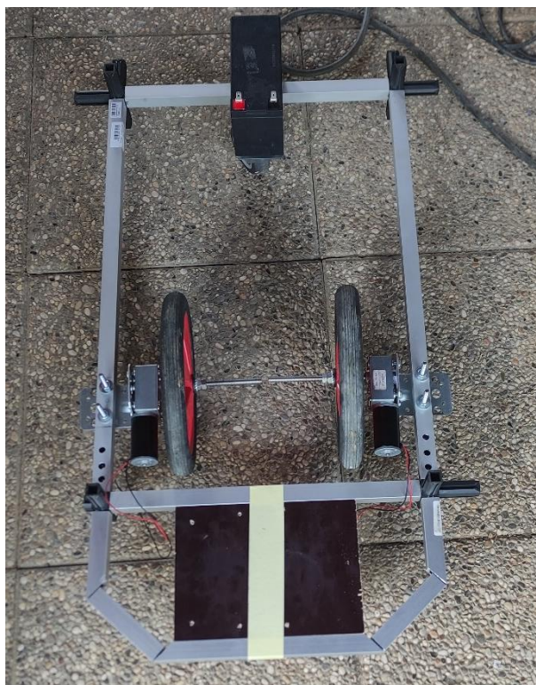
Slika 14. Izrada konstrukcije kosilice. Izvor: Nenad Vagan.
