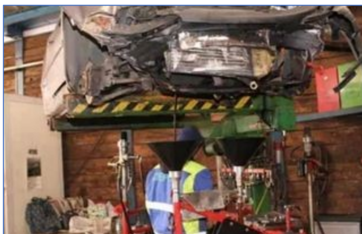
Slika 14. Izdvajanje opasnih tekućina [19]
