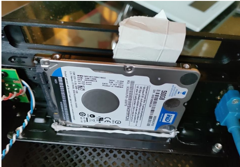
Slika 23. Ugradnja tvrdog diska korištenjem epoxy smole
