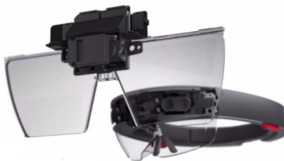
Slika 5. Kombinirane leće Izvor: https://www.microsoft.com/en-us/hololens (datum pristupa: 20.09.2021.)
