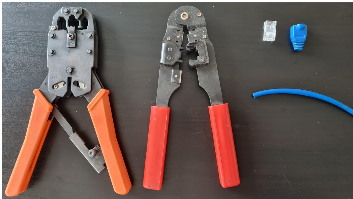
Slika 2: Materijali i alat za krimpanje kabela
