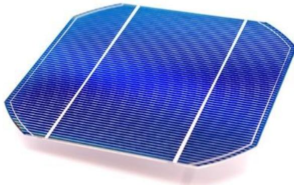
**Slika 25.** Fotonaponska čelija
