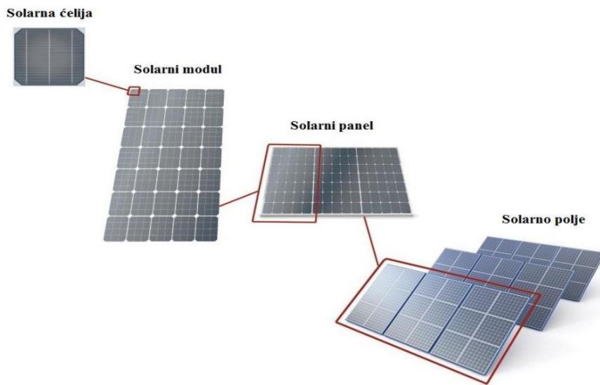
**Slika 26.** Sklapanje čelija u sustav
