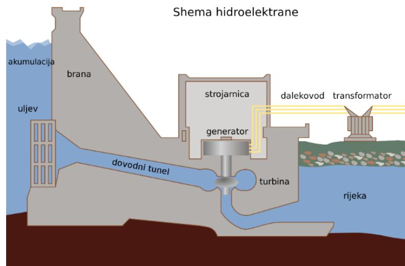
**Slika 13.** Prikaz dijelova hidroelektraneIzvor: [HEP Proizvodnja d.o.o. - Povijest](#) [13]
