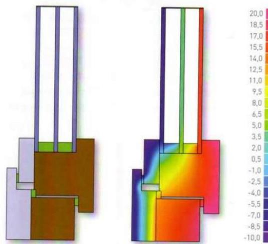
**Slika 6.** Temperaturni profili poprečnog presjeka trostrukog ostakljenog prozora s niskoemisijskim nanosom i argonom u međuprostoru
