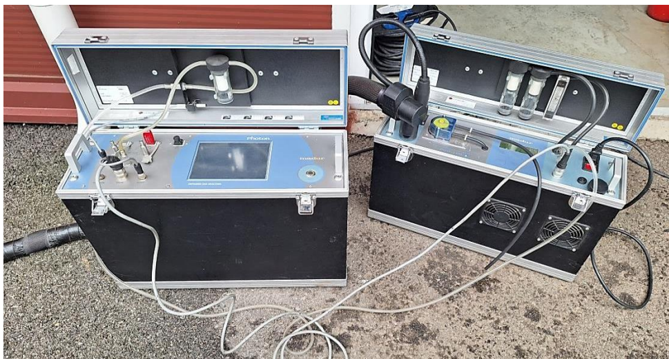
Slika 9. Analizator dimnih plinova proizvođača "Madur electronics" [31]
