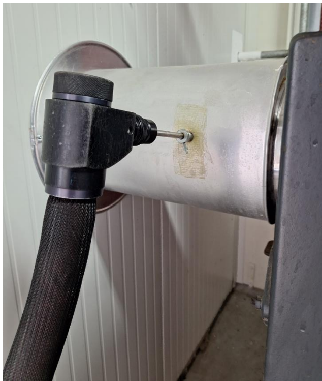
Slika 12. Sonda za uzorkovanje umetnuta u odvodni kanal [31]
