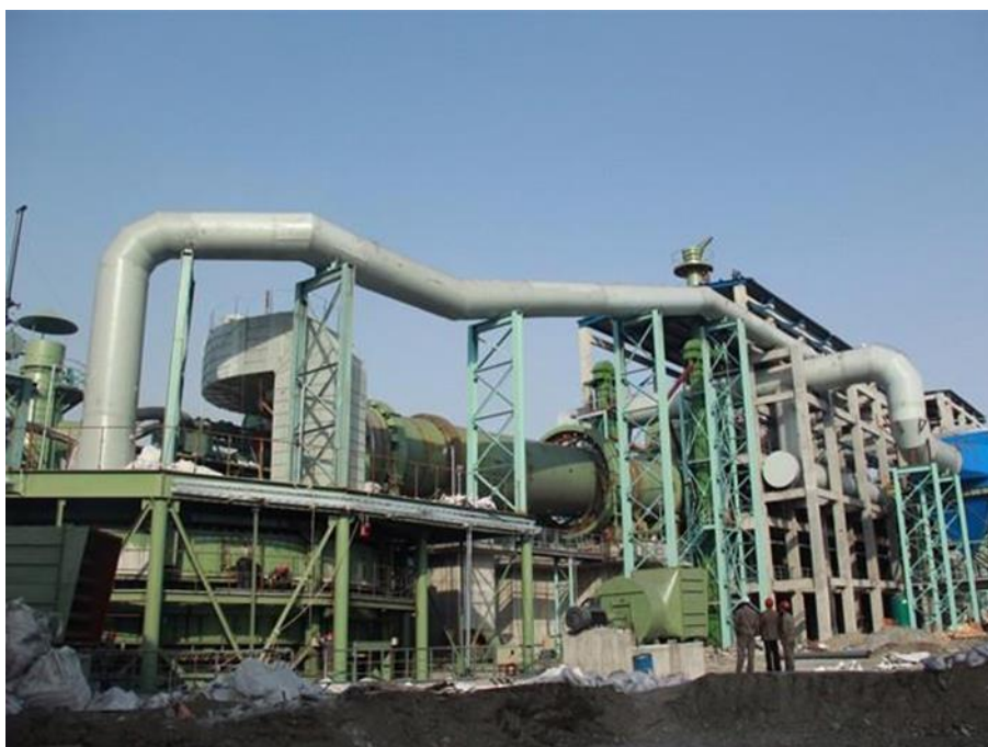
Slika 12. Peć prilagođena za spaljivanje medicinskog otpada
