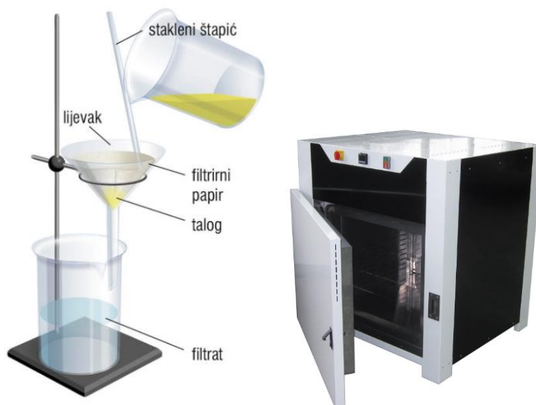
Slika 9. Prikaz filtracije i laboratorijska peć za sušenje
