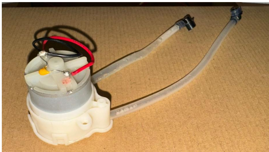
Slika 18 Vodena peristaltička pumpa
