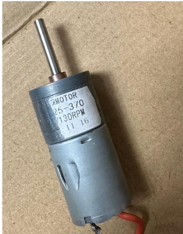
Slika 10 DC motor 6V 130 RPM
