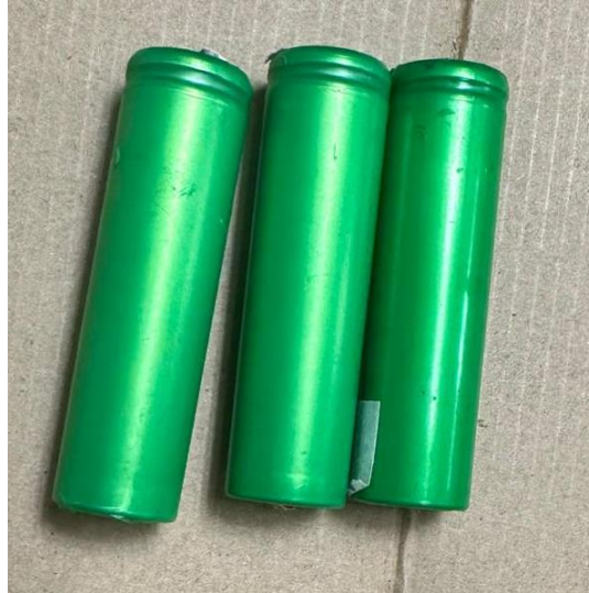
Slika 11 Litij-ionske baterije US18650
