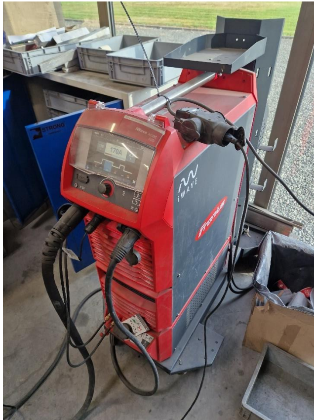
Slika 61. – Uređaj za TIG zavarivanje Fronius iWave 500i AC/DC
