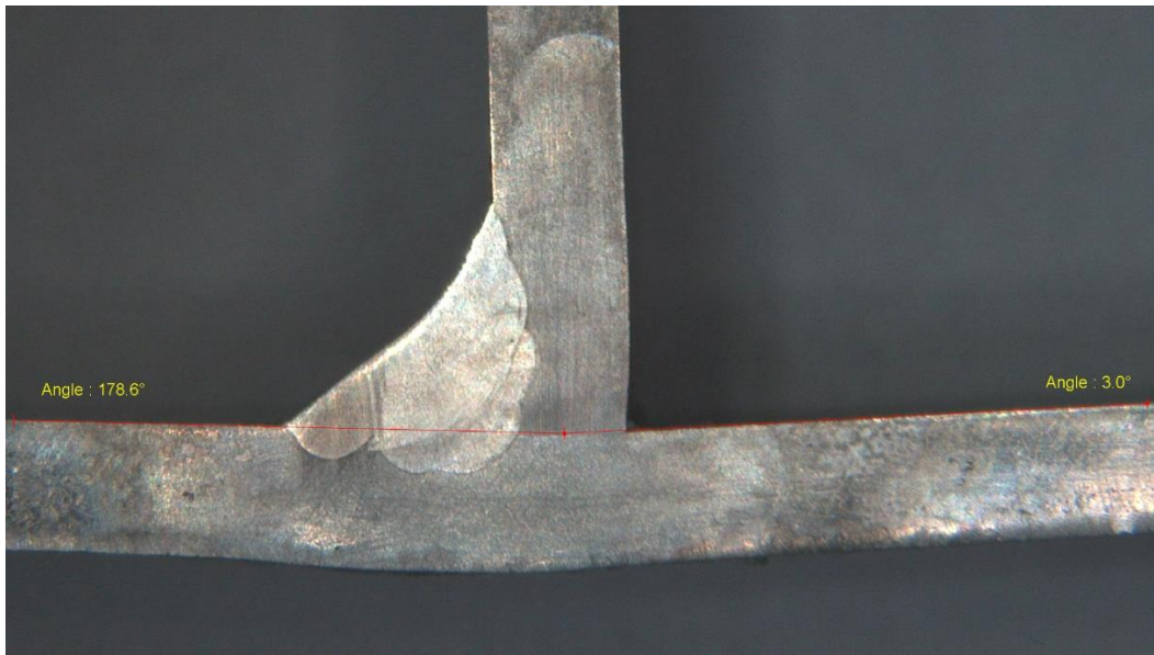
Slika 82. – Kutna deformacija TIG 3mm
