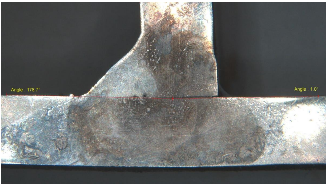
Slika 91. – Kutna deformacija MAG 6mm
