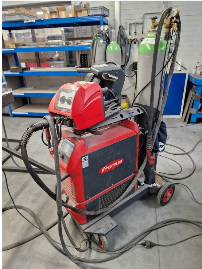
Slika 62. – Uređaj za TIG zavarivanje Fronius iWave 500i AC/DC
