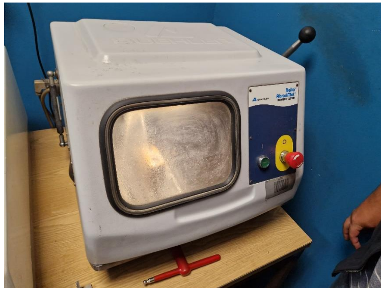
Slika 69. – Abrazivni rezač Beuhler Delta AbrasiMet
