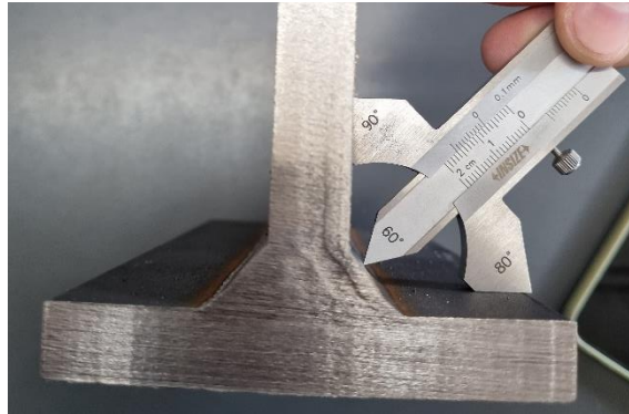
Slika 27. Mjerenje veličine zavora pomičnim mjerilom
