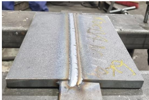
Slika 18. Zavareni sučeljeni zavar konvencionalnim MAG postupkom
