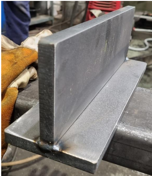
Slika 19. Priprema za kutni zavar konvencionalnim MAG postupkom
