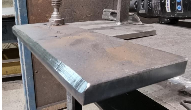
Slika 14. Priprema za zavar D-Arc
