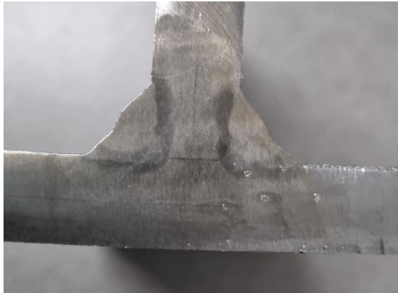
Slika 29. Makroizbrusak kutnog spoja zavarenog konvencionalnim MAG postupkom
