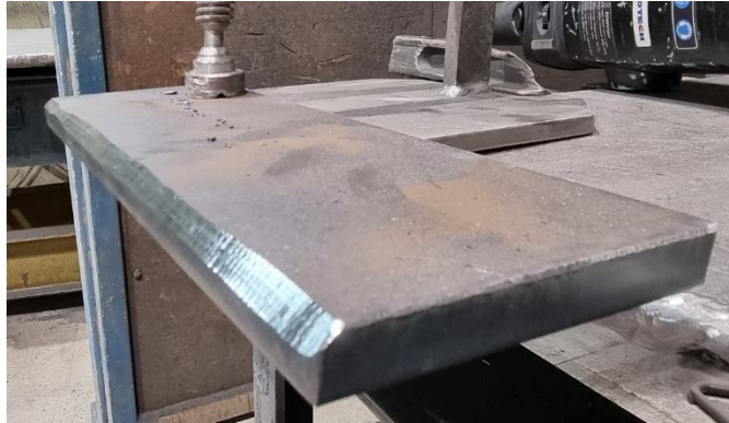
Slika 14. Priprema za zavar D-Arc
