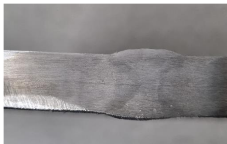
Slika 28. Makroizbrusak sučeljenog spoja zavarenog konvencionalnim MAG postupkom
