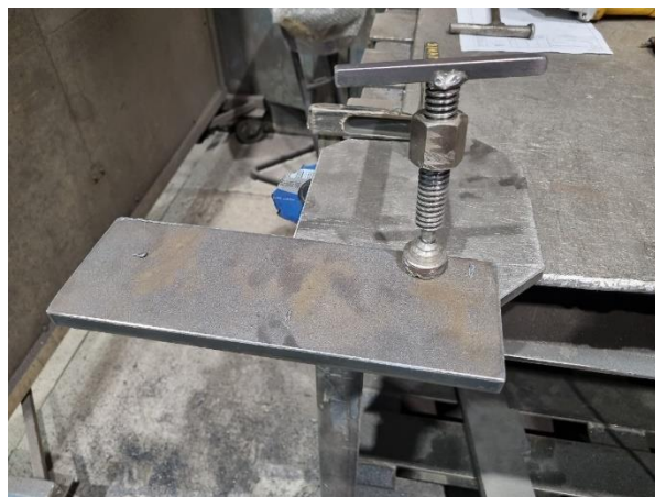
Slika 12. Stezanje radnog komada za radni stol
