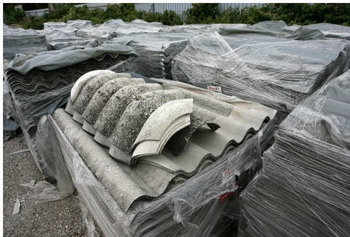
Slika 4. Opasni građevinski otpad - Azbestne ploče [1]
