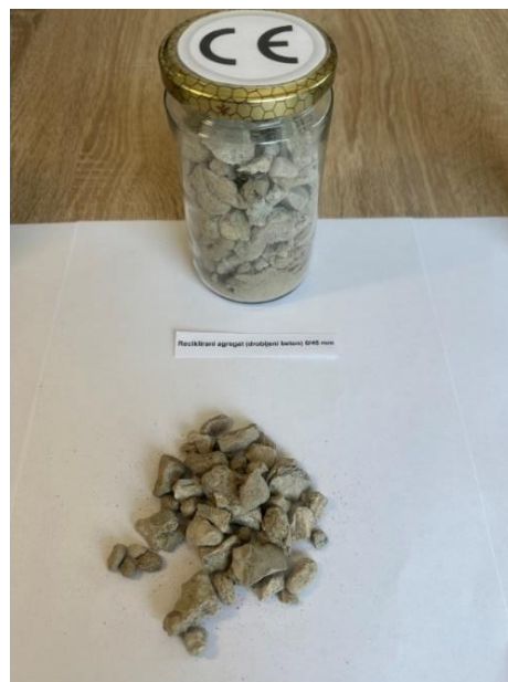
Slika 11. Reciklirani agregat (drobljeni beton) 0/45 mm [5]
