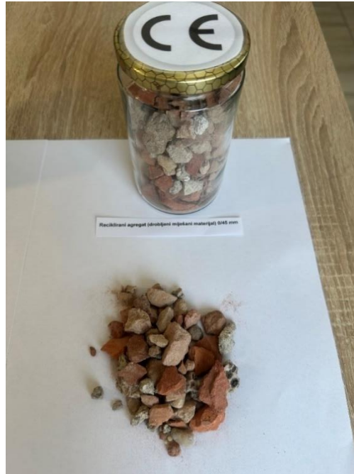
Slika 12. Reciklirani agregat (drobljeni miješani) 0/45 mm [5]
