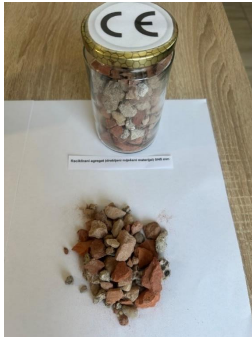
Slika 12. Reciklirani agregat (drobljeni miješani) 0/45 mm [5]
