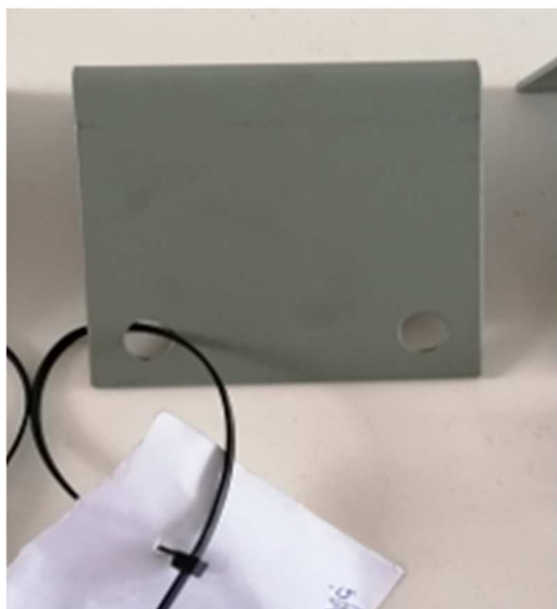
□) Kemijski obrađen testni uzorak
