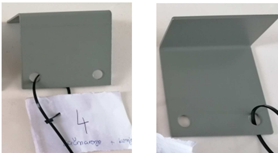
d) Sačmaren + kemijski obrađen testni uzorak
