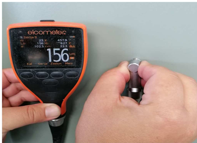
Slika 28. Elcometar za mjerenje mikrona
