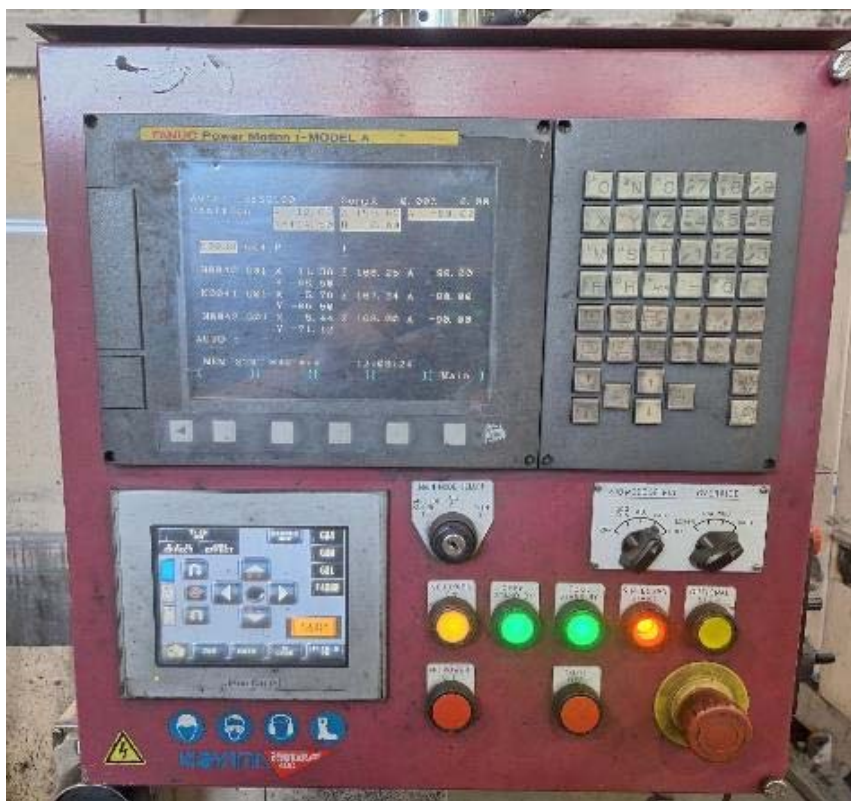
Slika 21. Upravljanje FANUC komandi panel, Ferro-Preis d.o.o.
