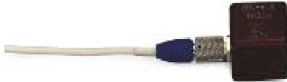
Slika 9. Akcelerometar za mjerenje vibracija [8]
