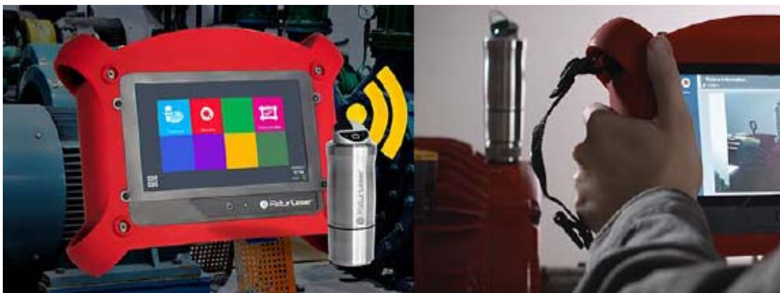
Slika 24. Fixturlaser uređaj za vibrodijagnostiku, Ferro-Preis d.o.o.
