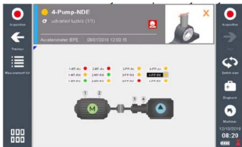
Slika 28. Pozicija mjerenja, Ferro-Preis d.o.o.
