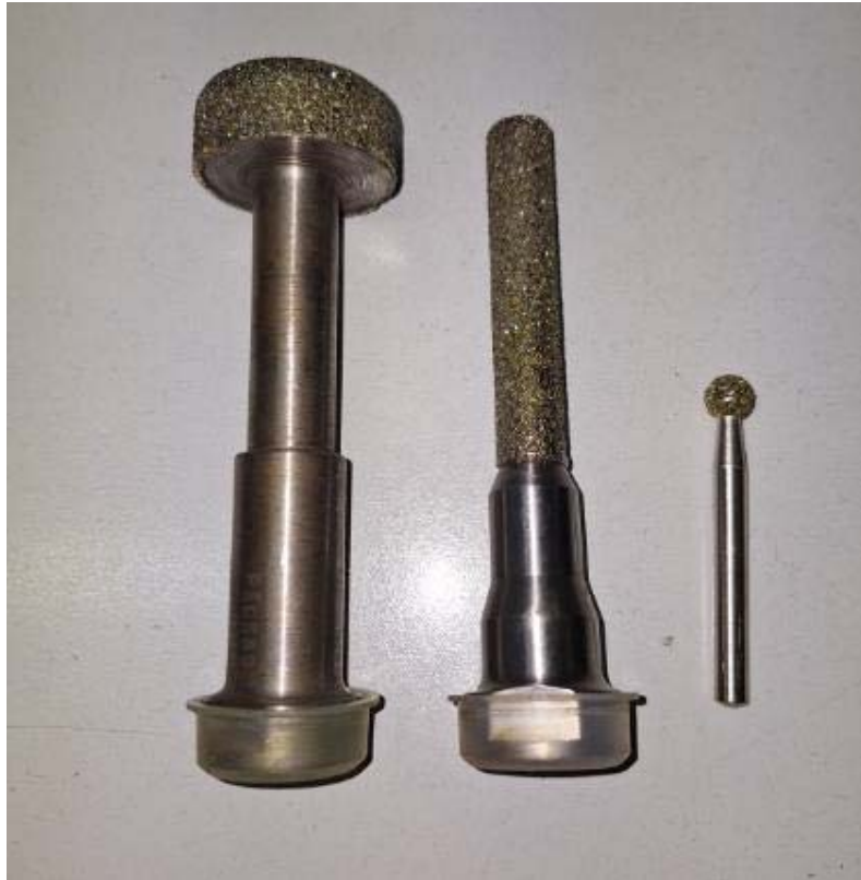
Slika 18. Dijamantna glodala, granulacija S851, Ferro-Preis d.o.o.
