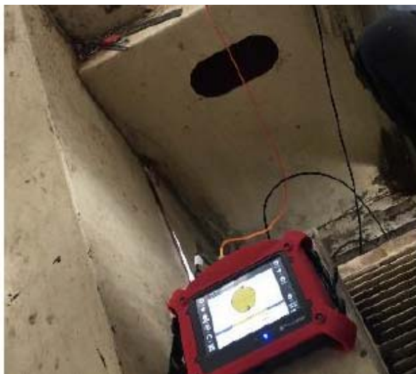
Slika 33. Supervisor za balansiranje u dvije ravnine, Ferro-Preis d.o.o.
