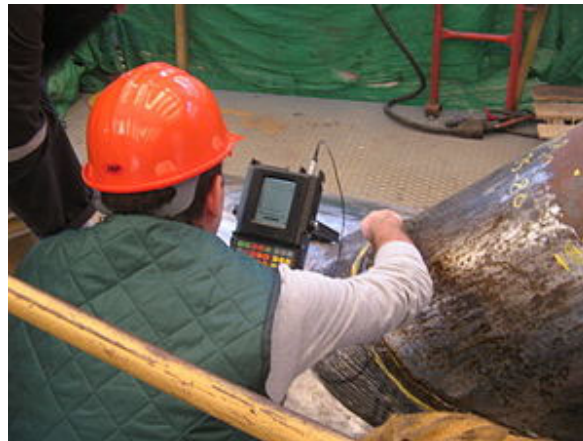
Slika 2. Ispitivanje zavora ultrazvukom
