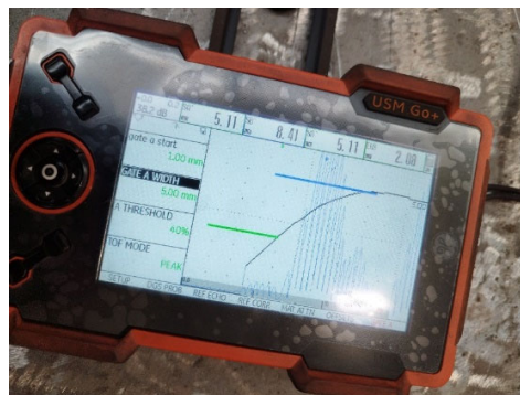
Slika 17. Digitalni prikaz očitavanja oštećenog dijela lima
