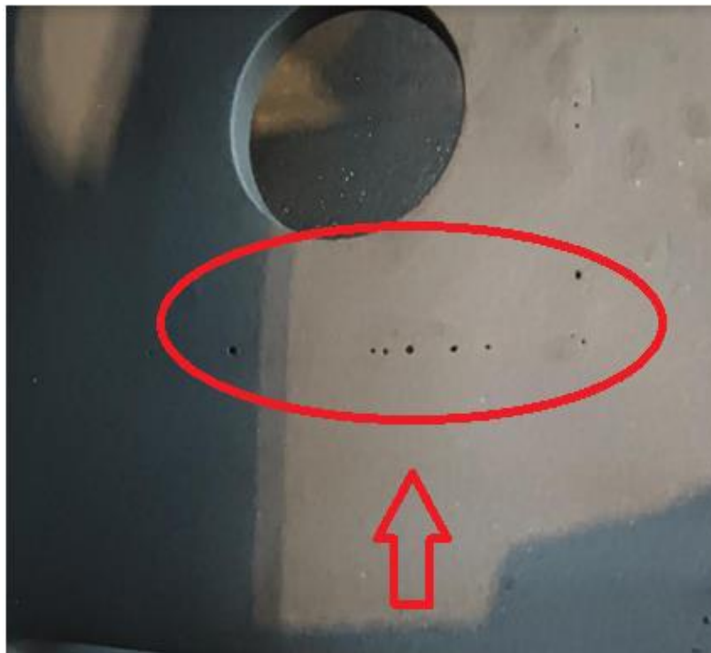
Slika 48. Poroznost na pobrušenom zavaru
