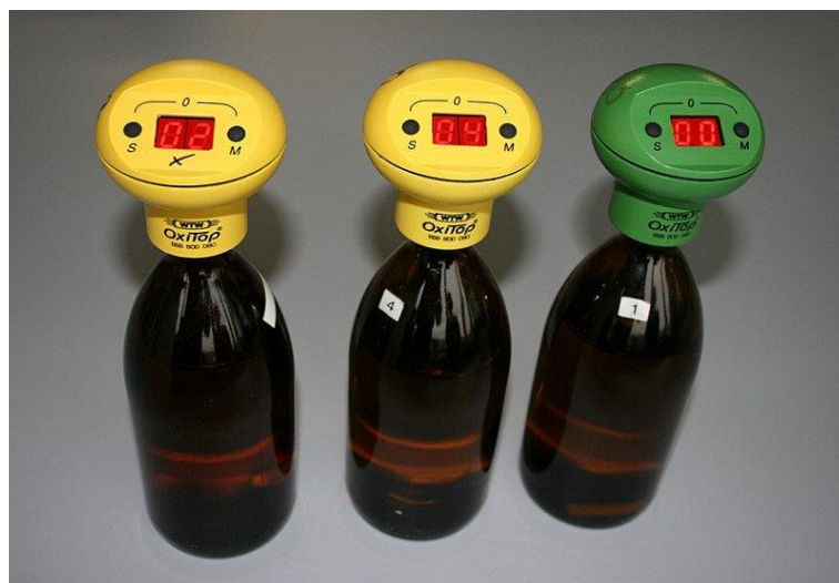
Slika 3: Boce tamnog stakla zatvorene Oxitopom
