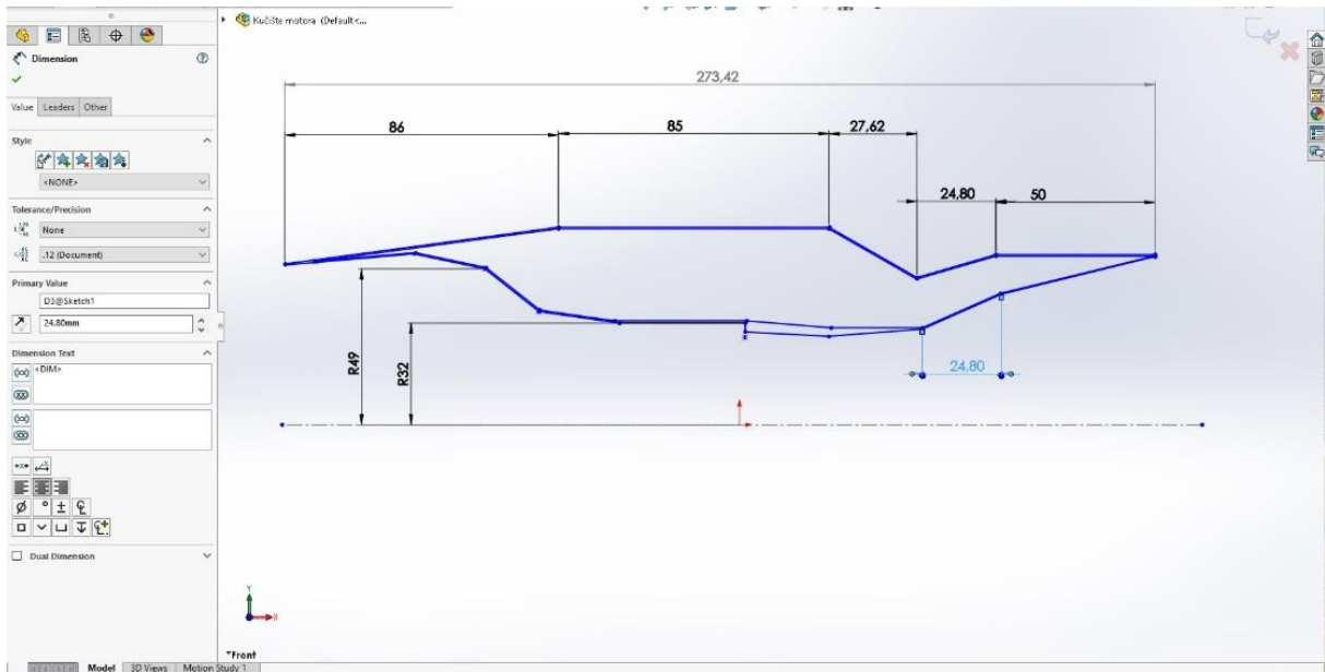
Slika 6. 2D konstrukcija kućišta mlaznog motora
