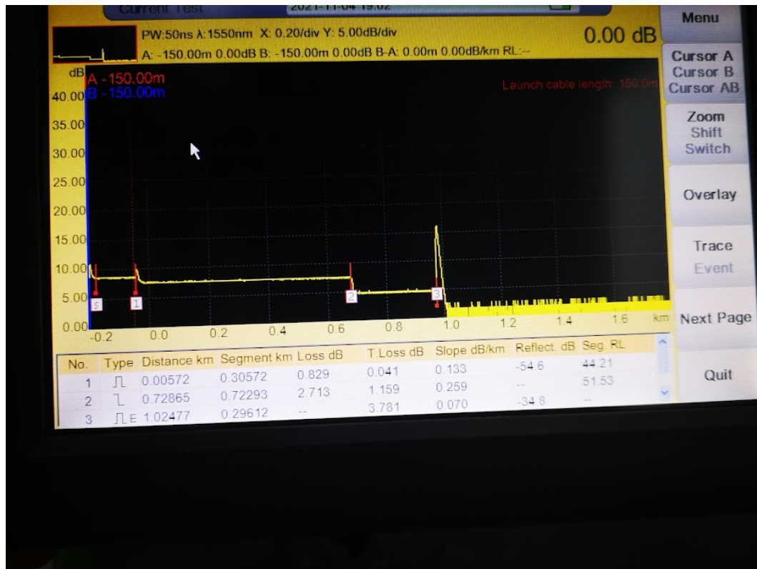
Slika 42. Prikaz rezultata na OTDR-u (Izvor: autor)
