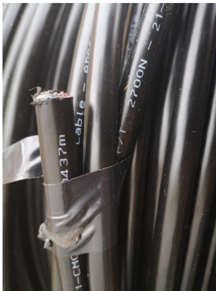
Slika 25. Prikaz svjetlovodnog kabela (Izvor: autor)
