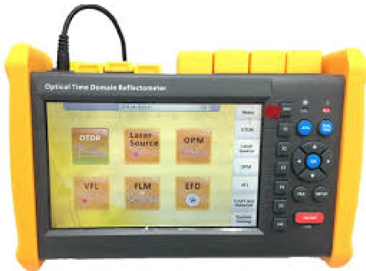
Slika 41. Prikaz OTDR uređaja (Izvor: http://www.robay-optical.com/products/fho5000-otdr , preuzeto: 18.05.2022)
