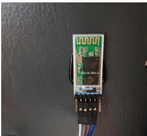
Slika 22. Spajanje bluetooth senzora. Izvor: Nenad Vagan.
