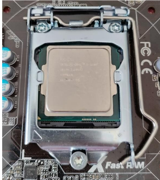
Slika 15. Instalacija centralne procesorske jedinice
