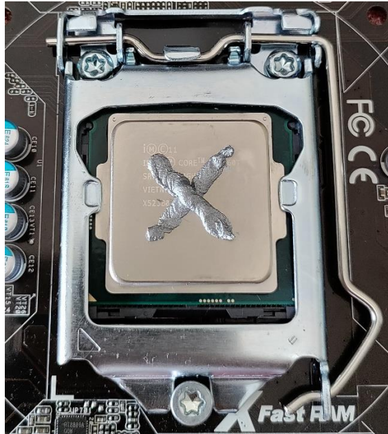
Slika 16. Postavljanje termalne paste
