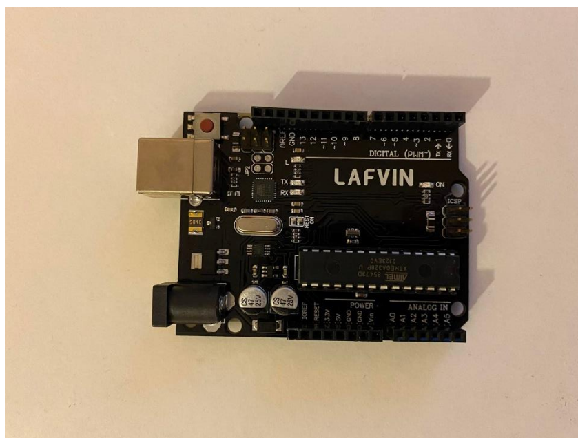
Slika 3. Arduino UNO. Izvor: Autor.
