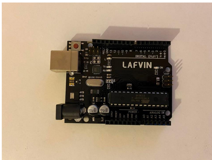
Slika 3. Arduino UNO. Izvor: Autor.
