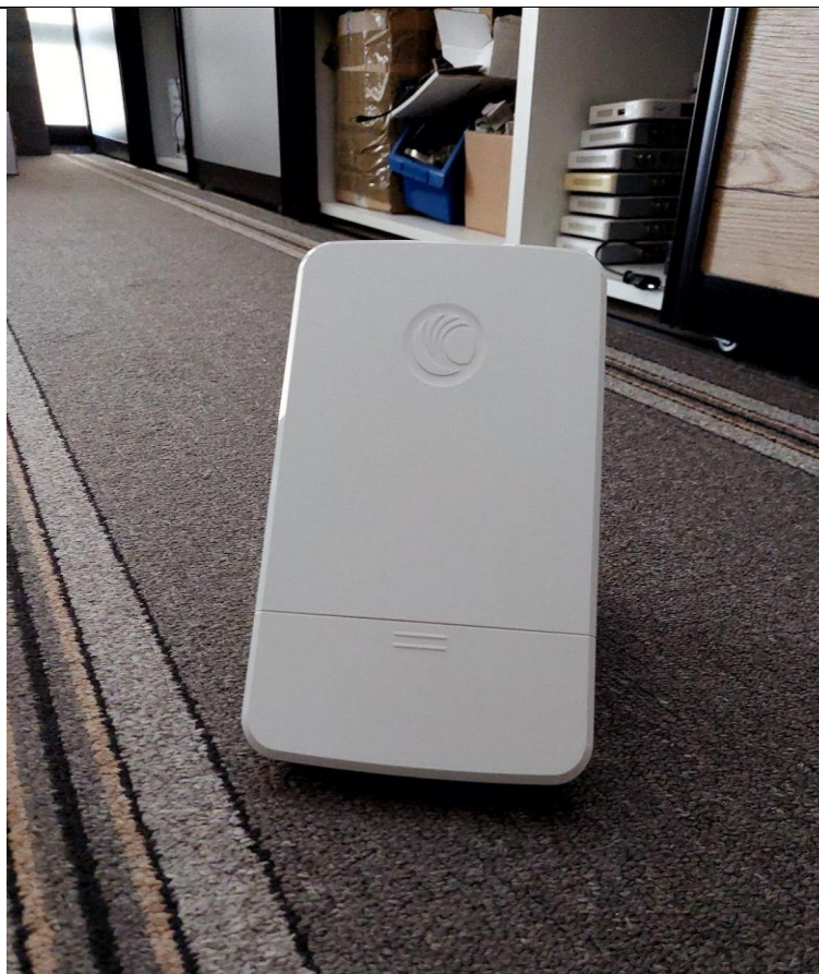
Slika 7. Cambium force 300-13 pretplatnički modul Izvor: Autor
