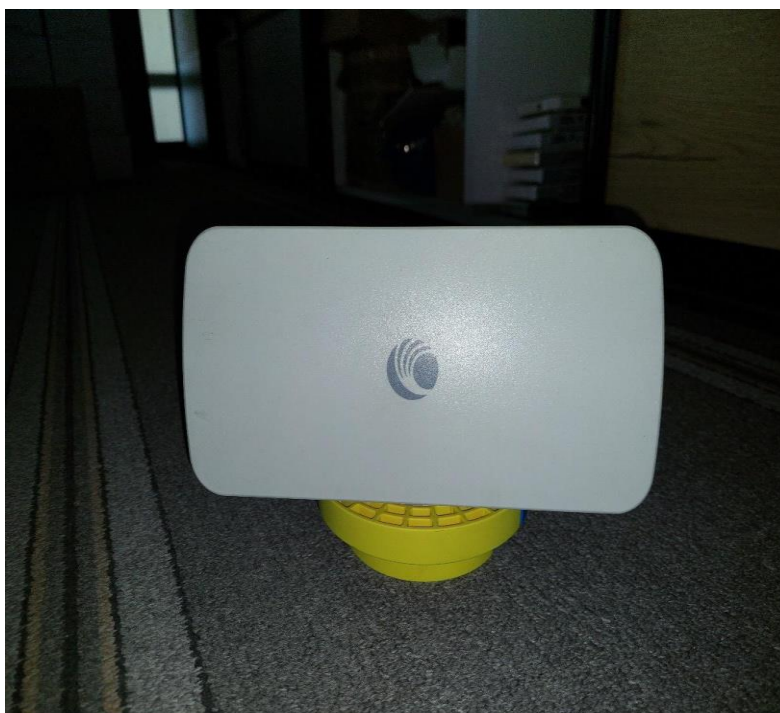
Slika 8. Cambium force 300-16 pretplatnički modul Izvor: Autor
