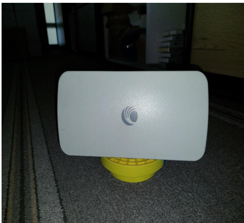
Slika 8. Cambium force 300-16 pretplatnički modul Izvor: Autor
