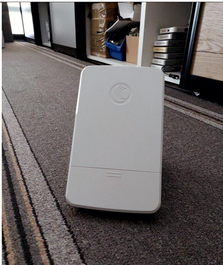
Slika 7. Cambium force 300-13 pretplatnički modul Izvor: Autor
