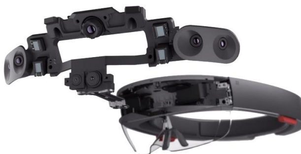
Slika 3. Prikaz senzora i kamera
