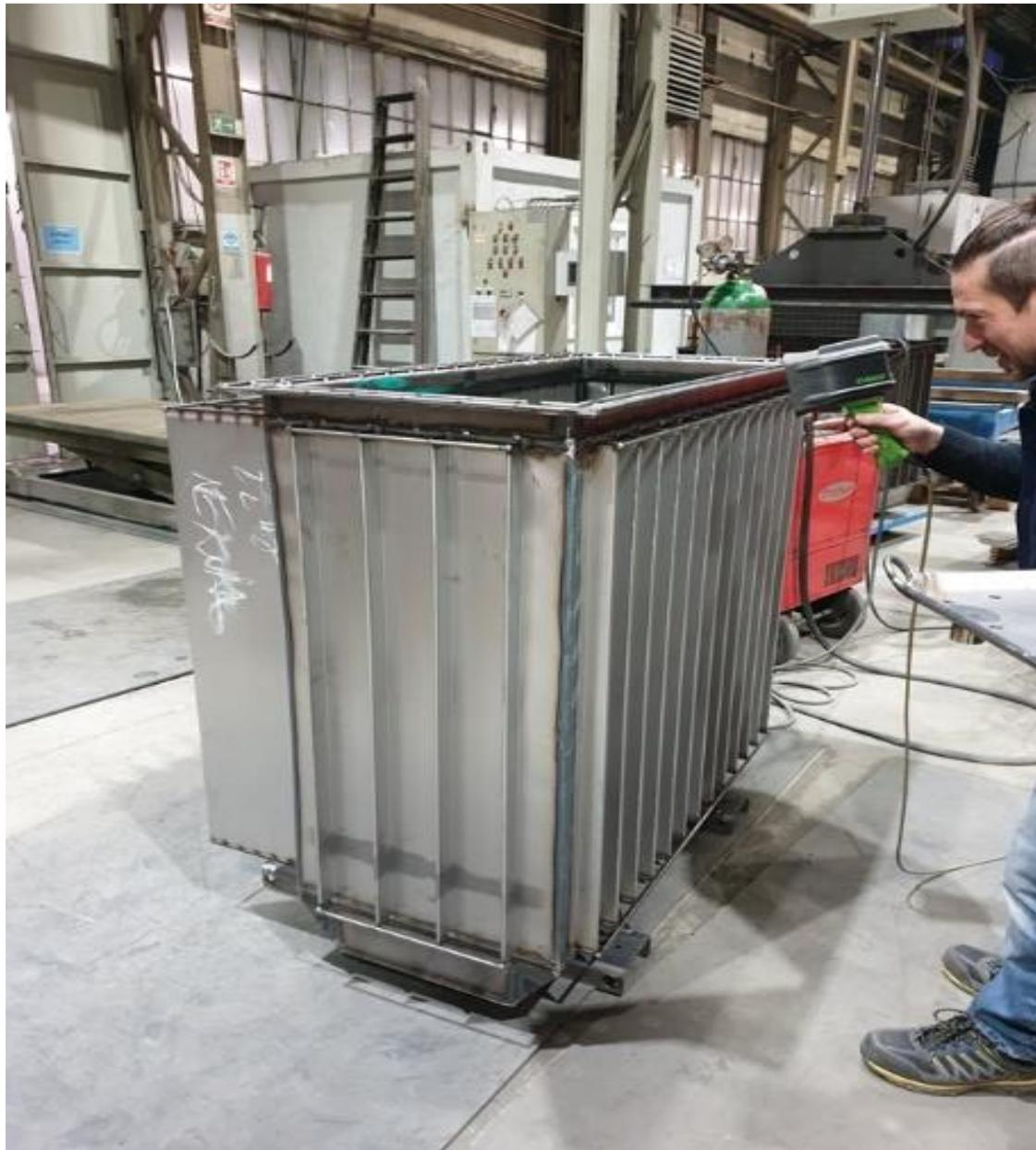
**Slika 13.** Ispitivanje UV lampom
