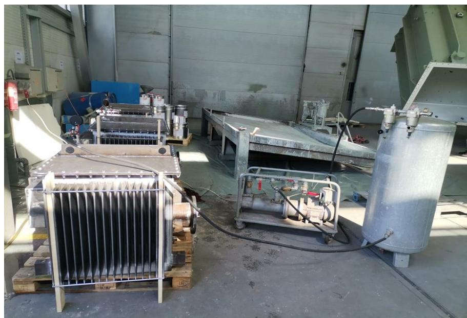
Slika 27. Tlačna pumpa
