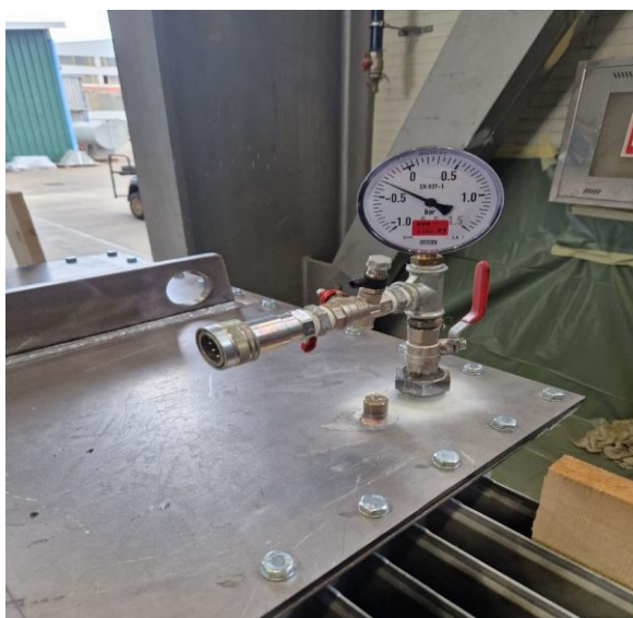
Slika 31. Manometar s vrijednošću od -0,3 bara
