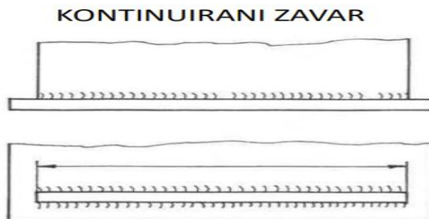
Slika 4. Kontinuirani zavareni spoj
