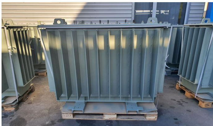
Slika 1. Prikaz distributivnog kotla
