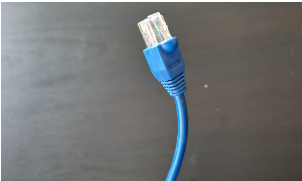
Slika 7: Kabel spreman za spajanje
