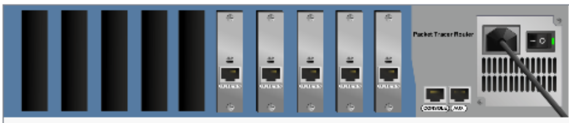
Slika 39: Upaljeni usmjerivač s pet priključnica
